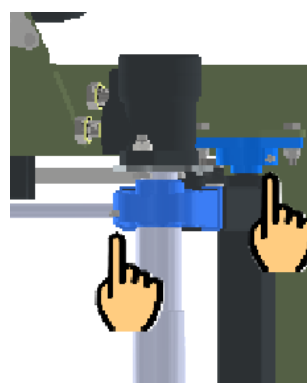
Figura 8.2 – Pontos de lubrificação das chumaceiras
