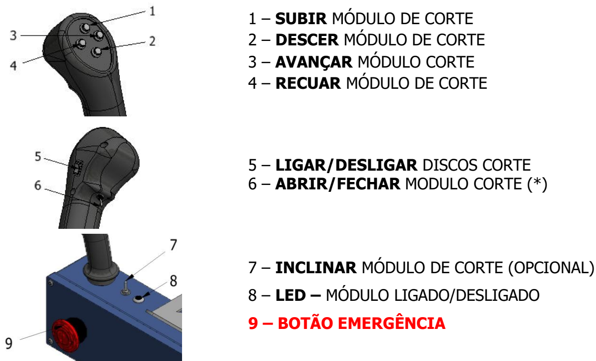
Figura 6.1 – Unidade de Comando – botões de acionamento
